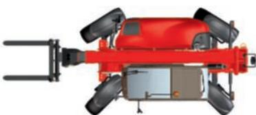
Allradlenkung für den kurzen Lenkeinschlag auf engen Baustellen
