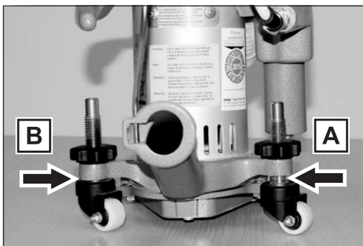
Abb. 79 Die Maschine schleift zu weit links : Die rechte Lenkrolle (A) hebt die Maschine weiter an als die linke Lenkrolle (B).
