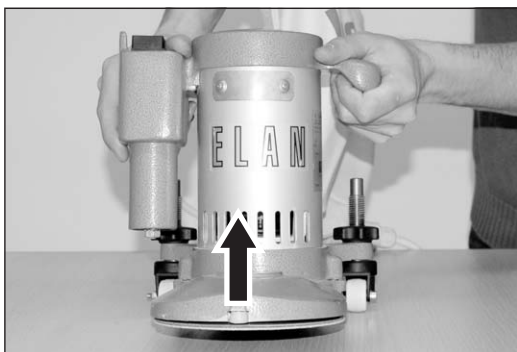
Abb. 10 Immer vor dem Einschalten und vor dem Ausschalten die Maschine etwas nach hinten kippen.
