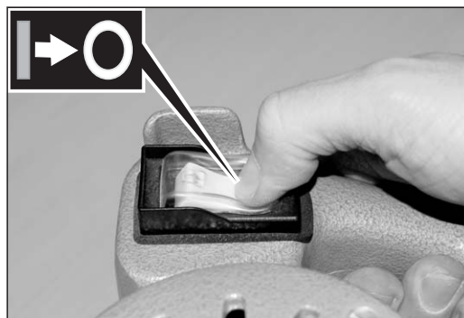
Abb. 12 Ausschalten der Maschine am Wippenschalter.
