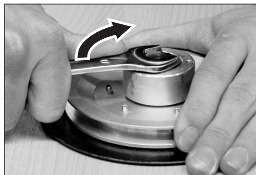
Abb. 54 Die Schleiftellerachse im Uhrzeigersinn (Linksgewinde) aus der Schleiftellerriemenscheibe schrauben.
