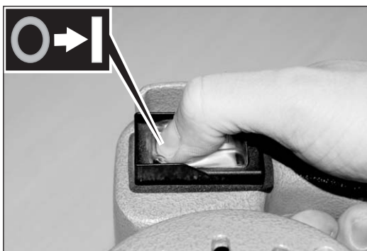
Abb. 11 Einschalten der Maschine am Wippenschalter.
