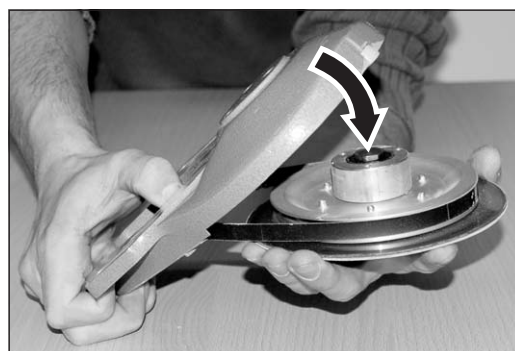
Abb. 42 Den kompletten Schleifteller mit dem Keilriemen in den Vorsatz einsetzen. Die Flucht des Lochbildes des kompletten Schleiftellers zum Lochbild des Vorsatzes beachten!
