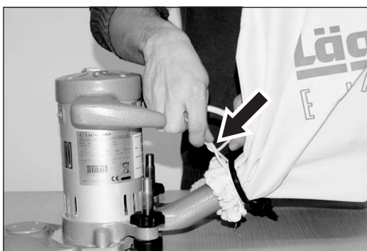
Abb. 7 Den Staubsack mit einer Schleife zubinden.
