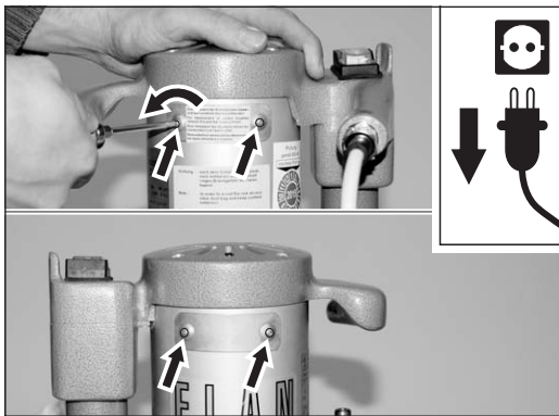
Abb. 61 Die beiden Abdeckbleche am Gehäuserohr des Motors entfernen.
