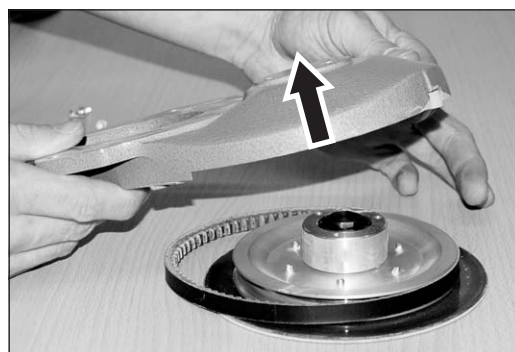
Abb. 50 Den Vorsatz von dem kompletten Schleifteller abnehmen.
