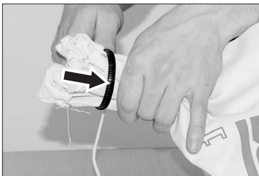
Abb. 5 Den MultiClip über den Staubsack schieben.
