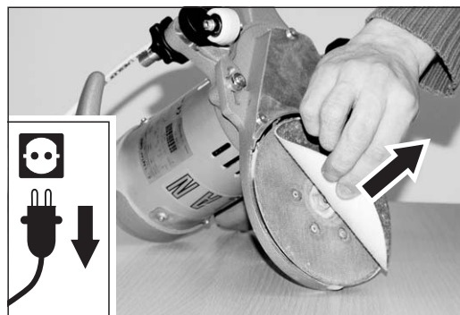
Abb. 21 Die Klettschleifscheibe vom Schleifteller abziehen.
