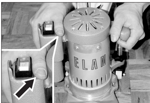
Abb. 13 Die ELAN mit beiden Händen führen. Während dem Schleifen NICHT den Schalterknopf berühren!
