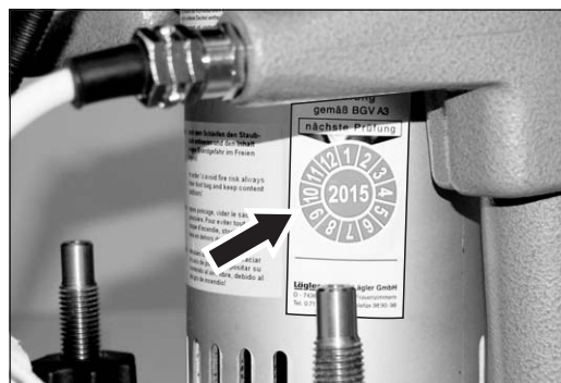
Abb. 81 Das Prüfsiegel am Motorgehäuse bescheinigt die elektrische und mechanische Sicherheit der Maschine.
