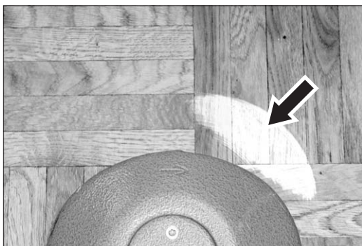
Abb. 76 Falsche Einstellung der Lenkrollen: Die Maschine schleift zu weit rechts .
