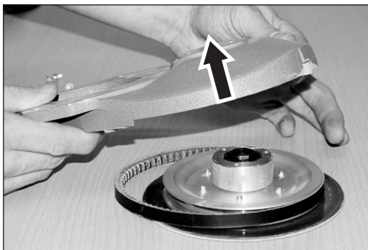
Abb. 40 Den Vorsatz von dem kompletten Schleifteller abnehmen.
