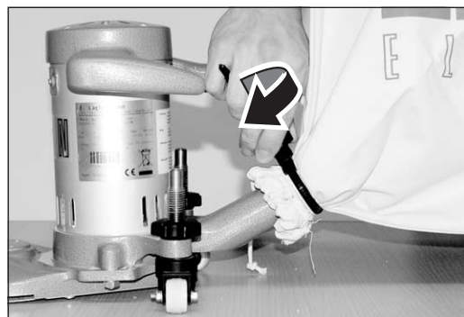
Abb. 8 Die Mutter am MultiClip handfest anziehen.
