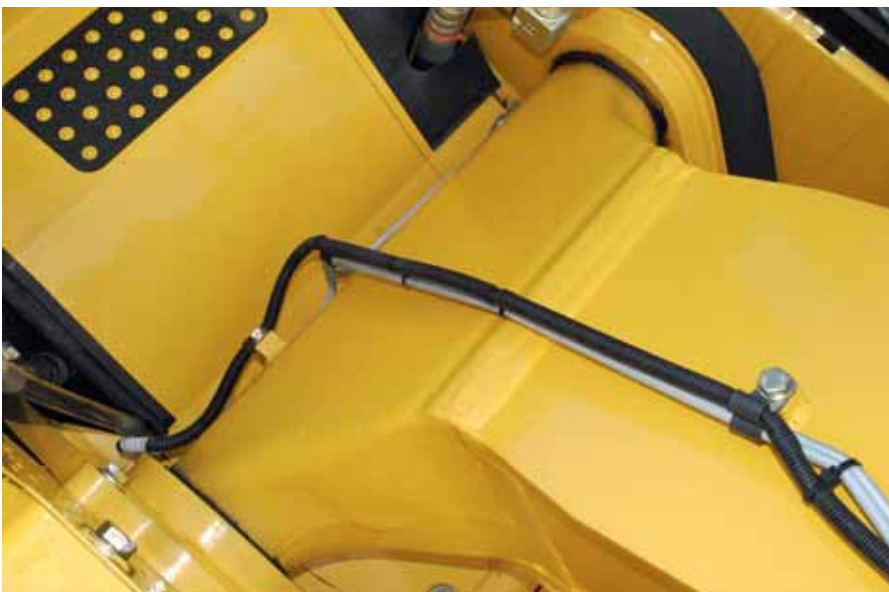
Auslegerfuß aus Stahlguss
