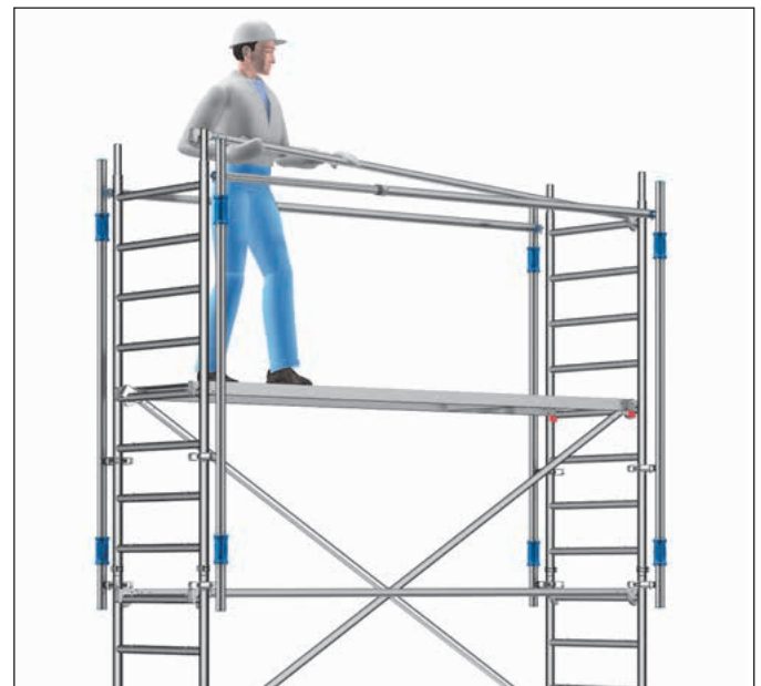
Bild 6: Sichere Montage der Rückenlehnen mit MSG
