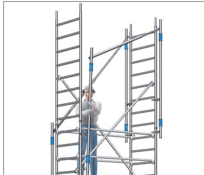
Bild 5: Versetzen des MSG nach oben
