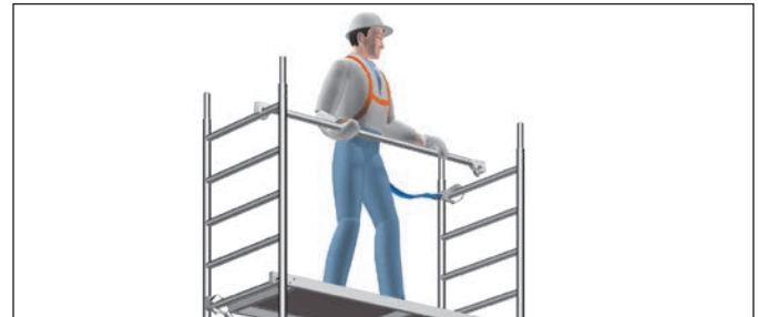
Bild 3: Sichere Montage der Rückenlehnen mit PSA
