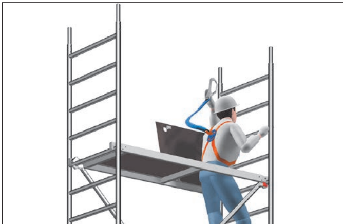
Bild 1: Anschlagen der PSA während des Aufstiegs in die ungesicherte Lage
