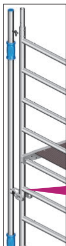
Bild 4: Anschluss Montagepfosten an der Standleiter
