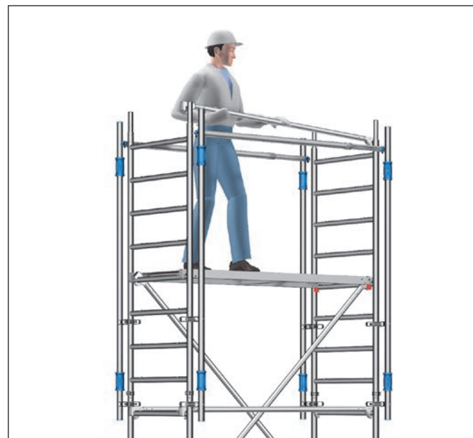
Bild 6: Sichere Montage der Rückenlehnen mit MSG
