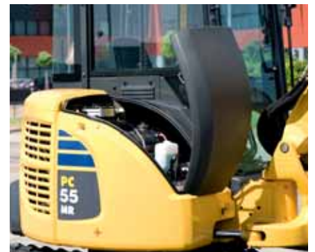
Vordere Wartungsklappe: leichtes Betanken
