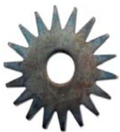
ET-5 Sternradchen Besteht aus vielen Spitzen für eine feine und regelmässige Oberfläche. Zum Entrosten, Reinigen und Farbanstrichen entfernen.
