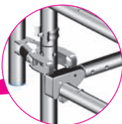
Bild 4: Anschluss Montagepfosten an der Standleiter
