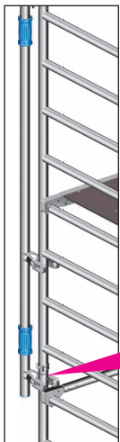
Bild 4: Anschluss Montagepfosten an der Standleiter
