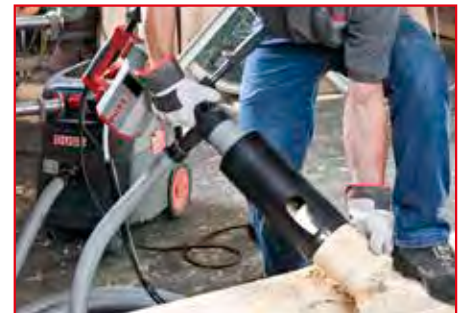
Bohren in Holz mit Staubabsaugung – handgeführt
